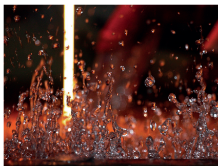
Фритта расплавляется при температуре 1450 °C
